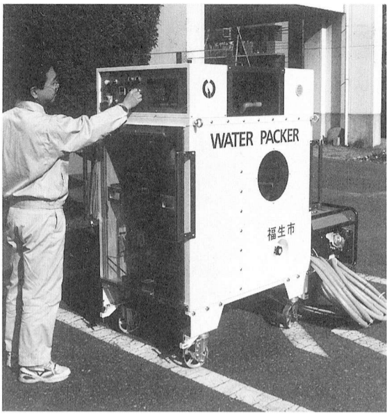
▲停電時は小型発電機で対応する飲料水袋詰め機
