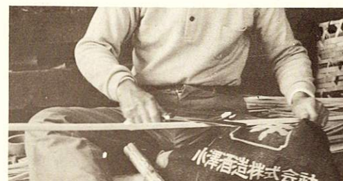
写真4 内側の節をけずる
