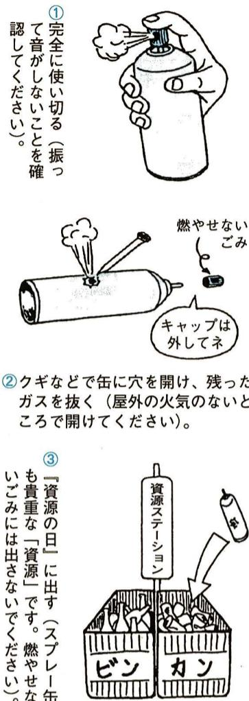
② キギなどで缶に穴を開け、残ったガスを抜く（屋外の火気のないところで開けてください）。
